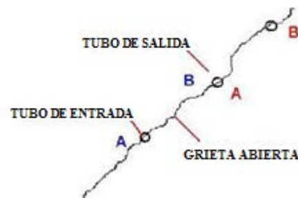
Figura 6.2.5 Esquema de una correcta inyección (Fernández, 1966)
