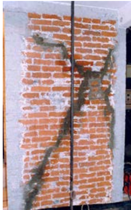
Figura 6.7.2 Reparación de grietas por rajuelo (Alcocer, 2019)
