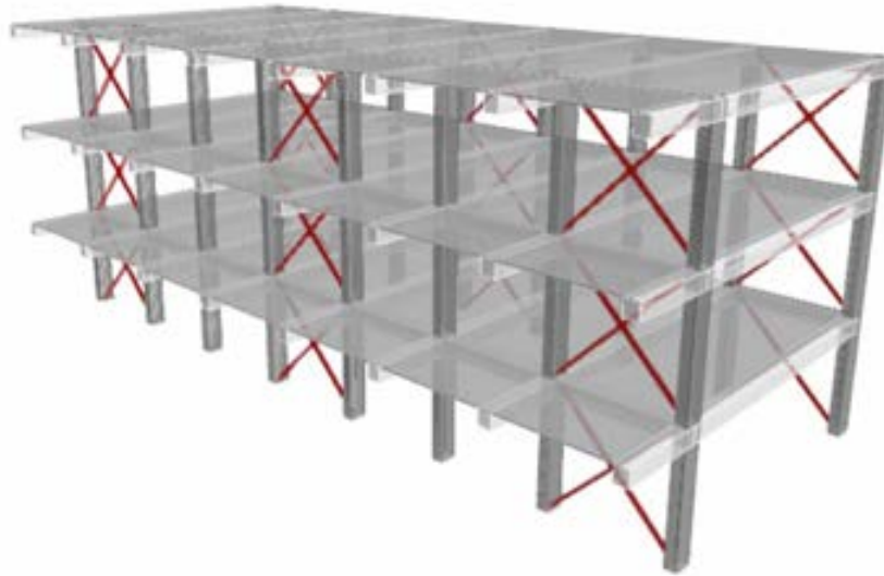
Figura 6.9.5 Ejemplo de rehabilitación mediante contraventeos concéntricos en el plano para un prototipo CAPFCE/INIFED U3C
